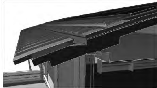
金属屋根軒先部分
