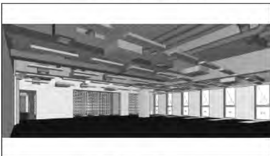
天井非表示による天井裏の確認
